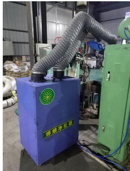
焊接用焊烟净化器
